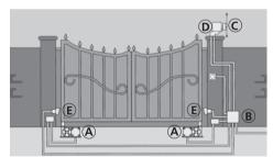
A Operador S700 H B Control maestro C Receptor D Lámpara señalamiento
